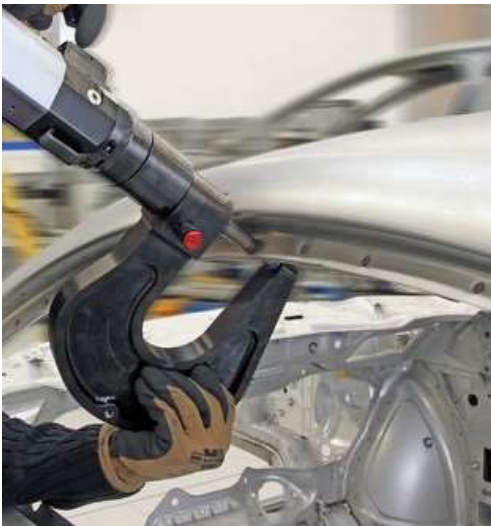
Het ponsen en lijmen gebeurt bij schadeherstel regelmatig
