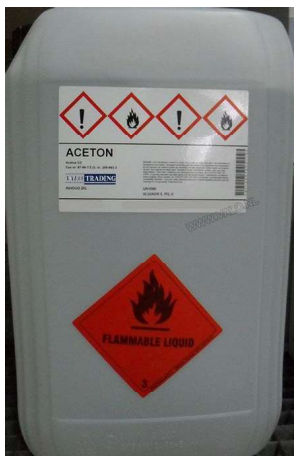
Ontvetten van polyester is erg belangrijk voor een goede hechting van de lijm. Aceton wordt veel gebruikt. Denk wel aan je PBM's
