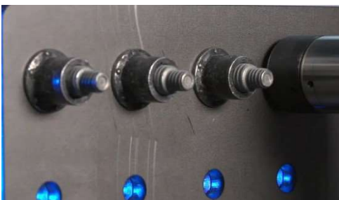
Zwaardere klinkbouten in een chassis van een vrachtauto
