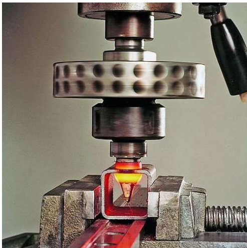
Voor vloeiboren heb je geen speciale machines nodig, met een kolomboormachine kan je heel goed vloeiboren
