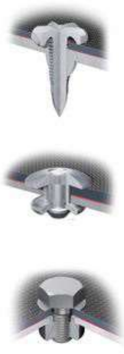
Een hybride verbinding met mechanische en lijmverbinding
