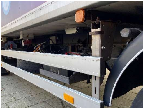
De hoogte van de reflectoren mag maximaal 1,2 m zijn als de reflectoren samen met een verlichting is gemonteerd
